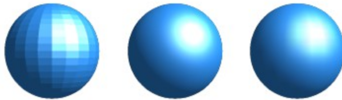
Abbildung 25: Flach-, Phong- und Gouraud-Shading
