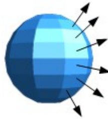
Abbildung 22: normalen (Vektoren) einer 3D-Kugel mit 10 Segmenten
